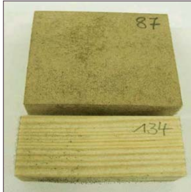
Fig. 4 : Échantillon de référence après le test de moisissure : Végétation clairement reconnaissable (en haut : MDF, en bas : aubier de pin).
